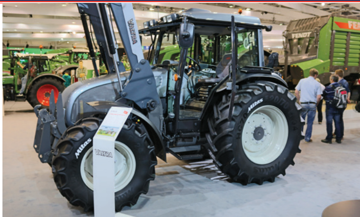
Traktor Valtra A-serie obutý na pneumatikách Mitas HC70 520/70R34 (zadní) a HC70 420/70R24 (přední).
